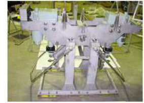
遠隔操作解体用機器
